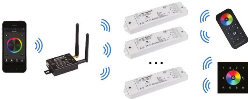
Рис. 1. Прямое подключение мобильного устройства к конвертеру (без использования домашней сети).
